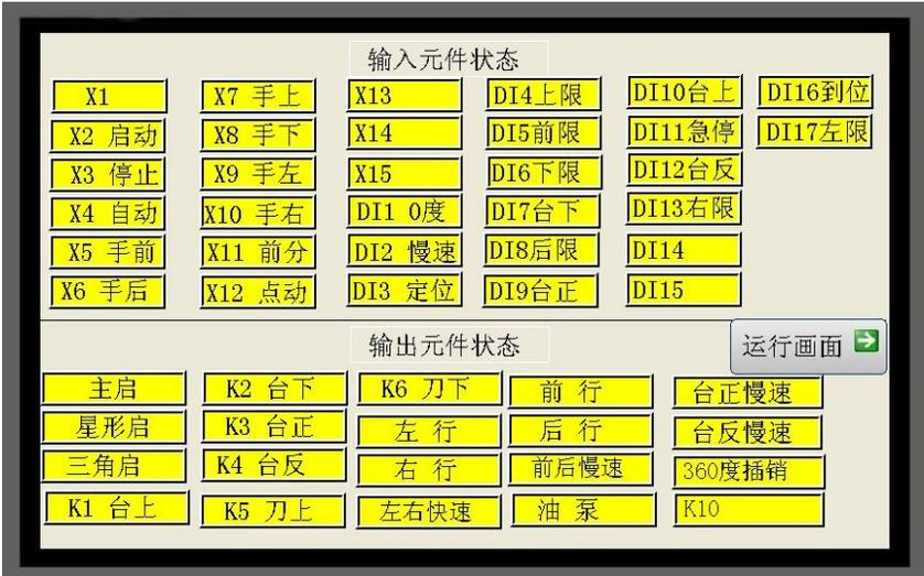
图 5-15 输入/输出元件界面
