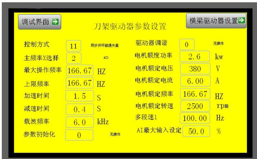
图 5-13 触摸屏刀架驱动器参数设置界面
