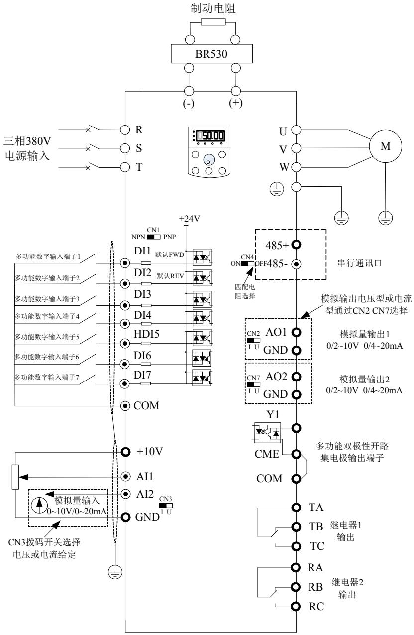
注意：CM530H 系列 30~93kW 制动单元部分属选配功能，CM530 系列 18~55kW 制动单元部分属选配功能，如有需求，订货时请说明。
