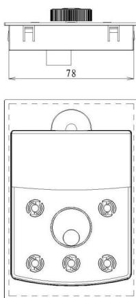
图2-7. 外引键盘带托盘安装尺寸图
