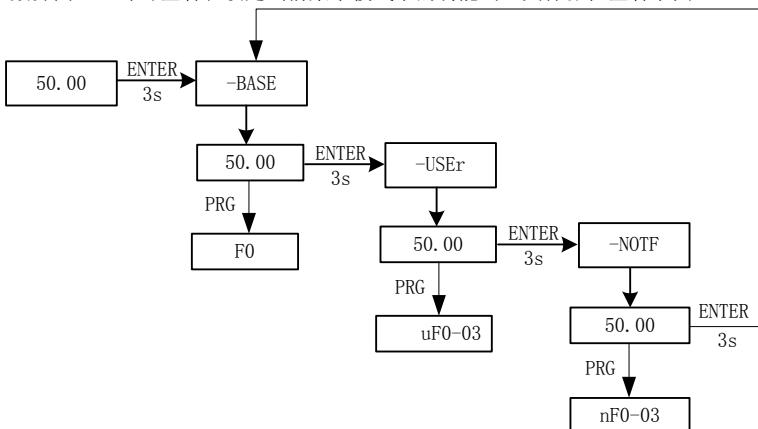
图 4-4. 菜单模式切换操作示意图
