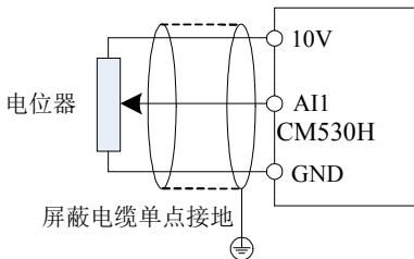
图 3-10. 模拟量输入端子接线示意图
