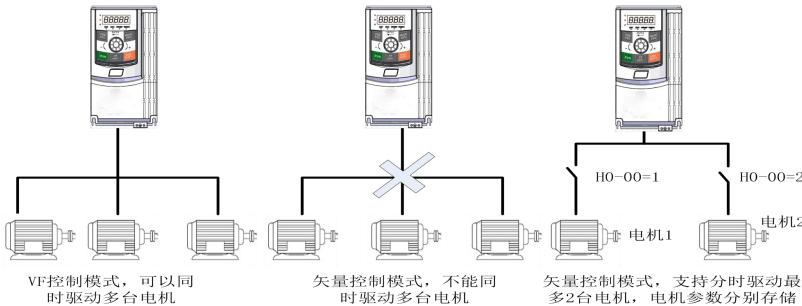
图 4-26. 多组电机的切换
