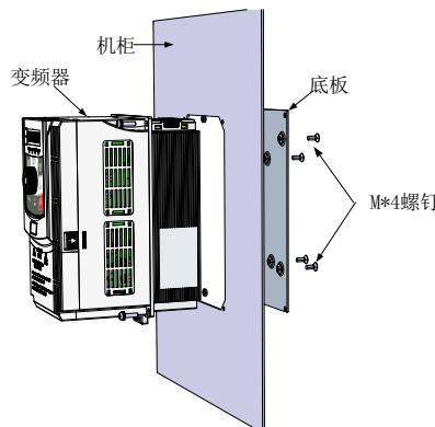
图3-3. CM530H变频器塑胶结构穿墙式安装图
