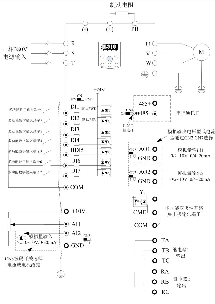
图 3-7. (4T/7T) 30kW 以下三相变频器
