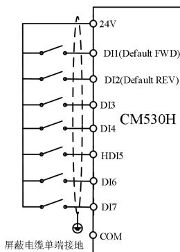
DI接线模式四：当DI拨码开关为PNP模式使用外部电源
