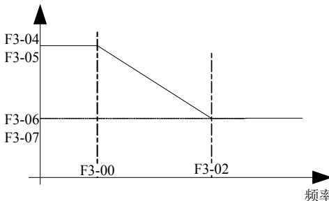
图 5-6. 速度环 PI 参数切换示意图
