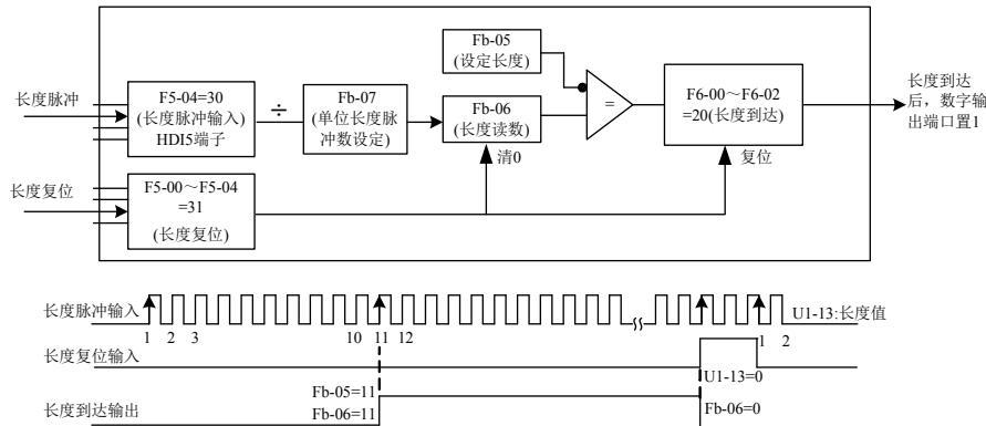
图 4-23. 定长控制模式功能码设置
