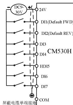
DI接线模式三：当DI拨码开关为PNP模式没有使用外部电源
