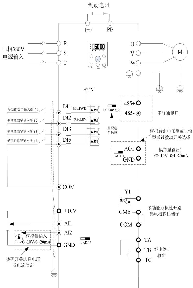
图 3-6. 1.5kW 以下三相变频器
