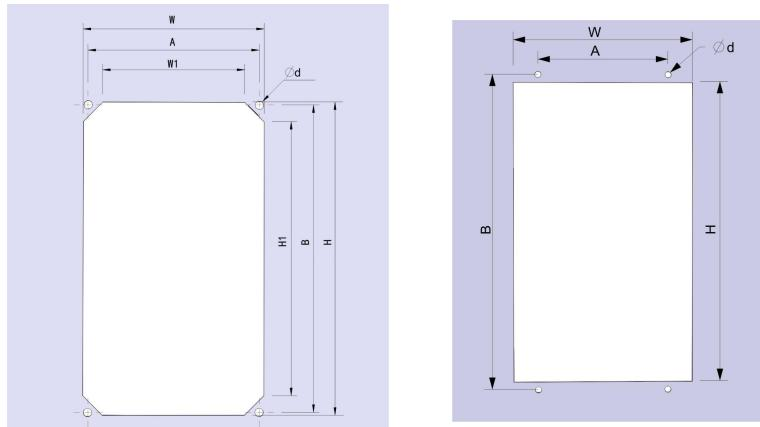
表2-5 CM530H变频器22kW以下穿墙式开孔尺寸及安装孔位尺寸
