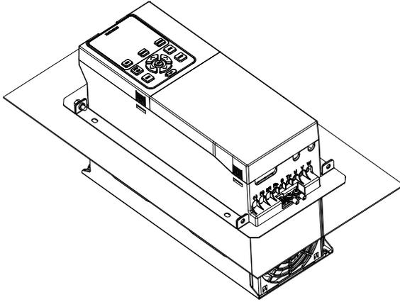
**图2-14 塑壳结构穿墙式安装方式**
