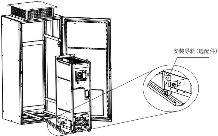
图2-24 脚轮对准安装导轨示意图
