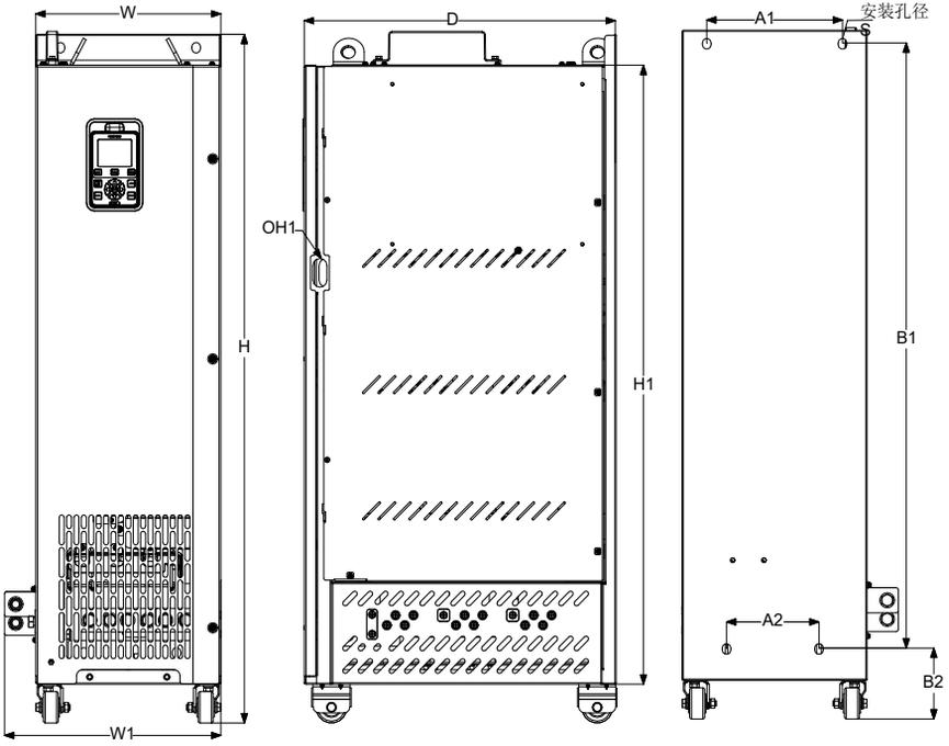
图2-5 (C9~C11) 380V(4T) 200~450kW变频器外型尺寸及安装尺寸示意图
