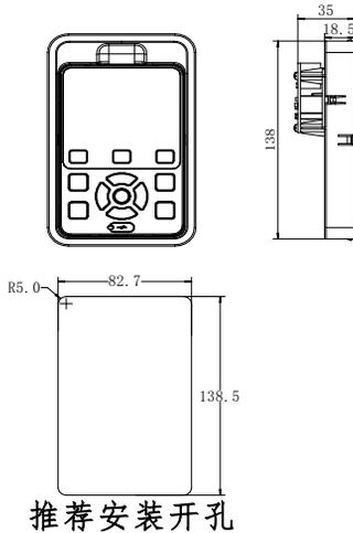
图2-11 外引键盘带托盘安装尺寸图
