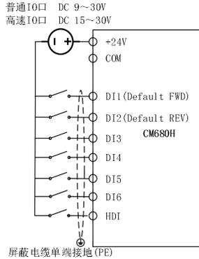
DI接线模式三：PNP模式没有使用外部电源
