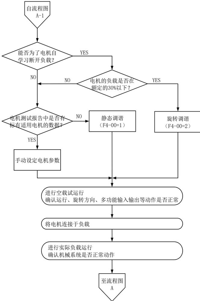
图4-2.闭环矢量控制方式运行步骤
