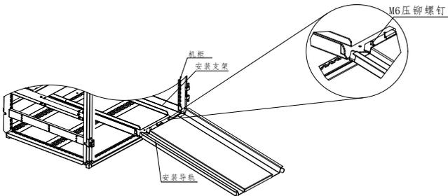
图2-23 安装导轨机柜内安装示意图
