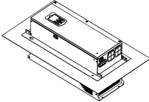
图2-16 钣金结构穿墙式安装方式
