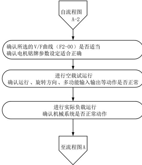
图4-3. V/F控制方式运行步骤
