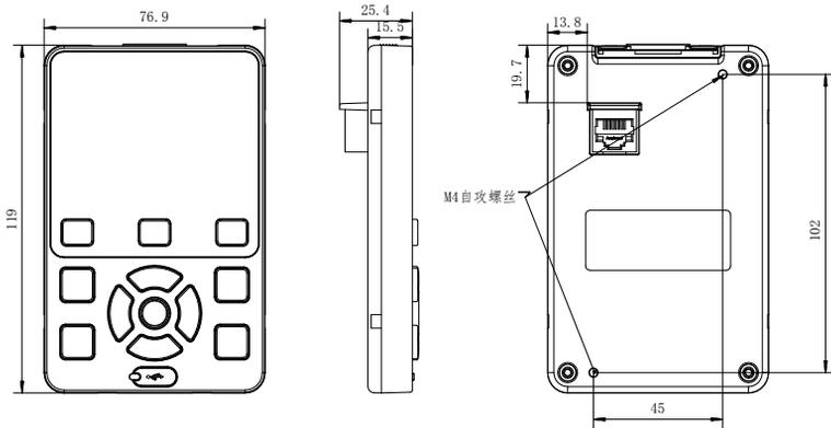
图2-12 外引键盘不带托盘安装尺寸图
