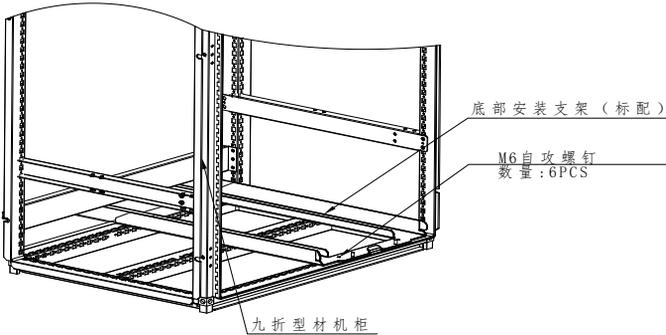
图2-22 底部安装支架安装示意图
