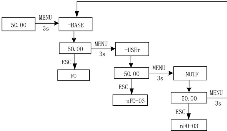
图 5-5. 菜单模式切换操作示意图
