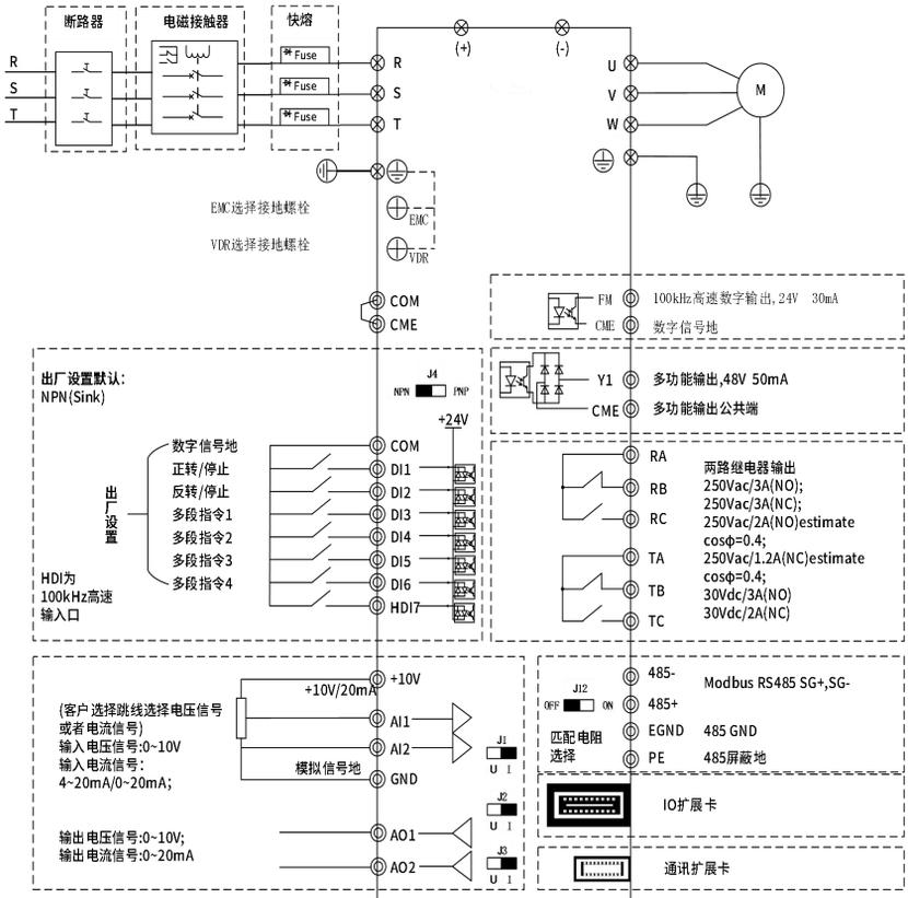
图3-3 160kW~450kW三相变频器
