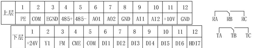
图3-4 控制回路端子布置图
