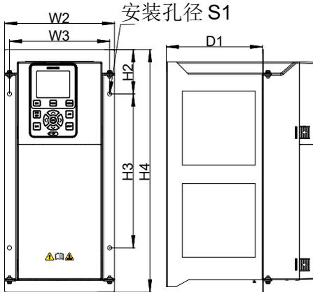
图2-7 (C4) CM680H-4T变频器18.5 ~ 30kW尺寸图
