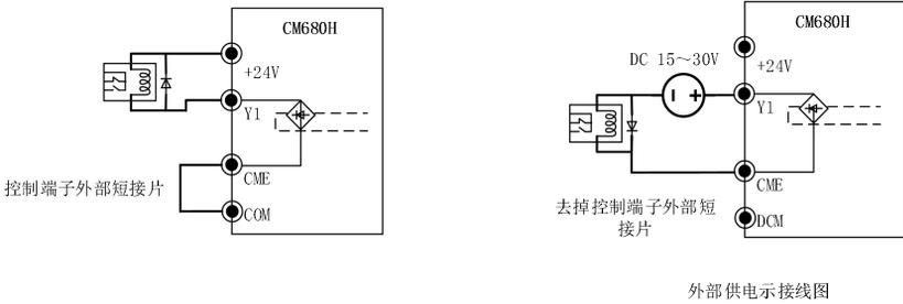
图3-6 数字输出端子Y1接线示意图
