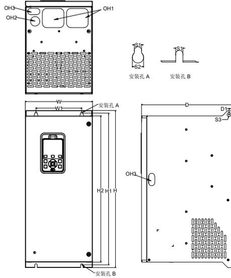
图2-4 (C6~C8) 380V(4T) 55~185kW变频器外型尺寸及安装尺寸示意图
