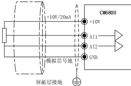
图3-5 模拟量输入端子接线示意图
