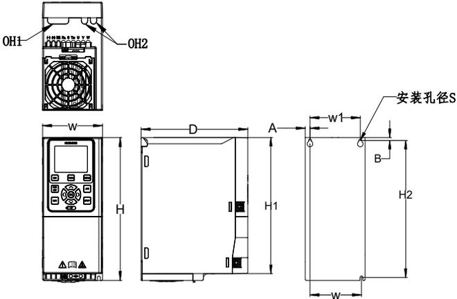
图2-1 (C2 ~ C3) 380V(4T) 15kW以下塑胶外形尺寸及安装尺寸示意图
